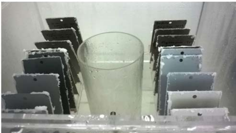
Test de Cámara de Niebla Salina-Tiempo de exposición.
